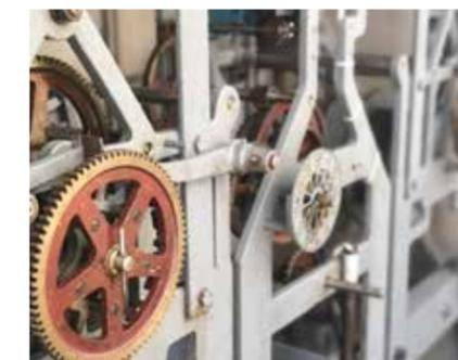
Dick klebt der Dreck seit Jahrzehnten auf den ausgebauten mechanischen Komponenten, die nun in der Werkstatt der Firma Rüetschi gereinigt, revidiert und wieder zum ursprünglichen Gehwerk komplettiert werden. Sieben Fachleute sorgen dafür, dass unsere Uhr dem Quartier wieder ein verlässlicher Taktgeber sein darf.
